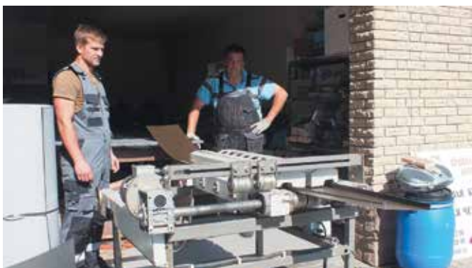
Технологический процесс изготовления фальцевых картин на станке электрического типа (общий вид от заготовки до готового изделия) на территории подведомственного объекта
