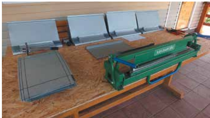
Предварительная подготовка – организация рабочего места кровельщика-жестянщика перед началом работ
