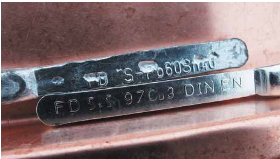
Стержни припоя двух типов – для меди (97% свинца & 3% меди) и титан-цинка (40% свинца & 60% олова)
