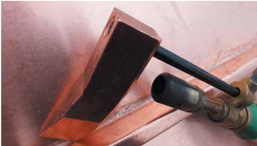
Насадка для паяльника в виде топорика весом 350 грамм на фоне вытянутого газового сопла обеспечивающего бесперебойный поток газа при сильных порывах ветра
